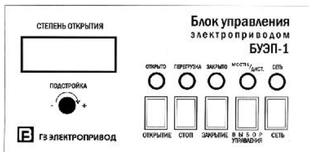
Рис. 2 Лицевая панель блока БУЭП, БУЭП(У)
