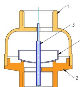
Внутри корпуса, выполненного из двух латунных (CW617N) деталей 1 и 2 свободно перемещается по направляющим шток 3, к которому приварен поплавок 4. Шток и поплавок выполнены из нержавеющей стали AISI 304. В обычном положении поплавок находится в верхней позиции, не препятствуя естественной циркуляции теплоносителя. При включении циркуляционного насоса, расположенного на обводящем участке (байпасе), клапан закрывается, включая в работу обводящий участок.
