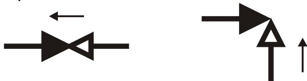
Условное графическое обозначение клапана обратного **проходного** на чертежах и схемах, стрелка указывает направление потока.
