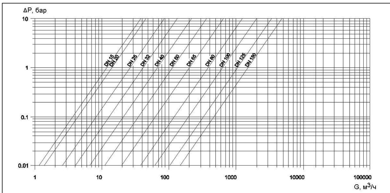
Рис. 3. Диаграмма выбора шарового крана JIP.
