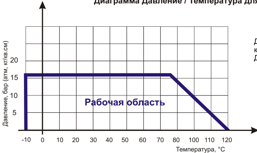
Диаграмма Давление / Температура для клапана обратного ABRA-D-122
